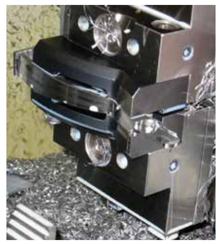
Mechanischer Zentrischspanner MZS 180-80 B mit Sonderbacken
