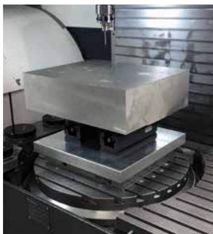
Mechanischer Zentrischspanner MZU 360-125; maximales Werkstück
