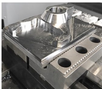
Механические центрирующие тиски MZU с переставными губками типа „Grip“
