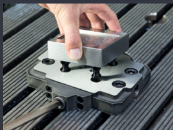
4-поз. зажимное приспособление ZPS, смонтированное на столе станка
