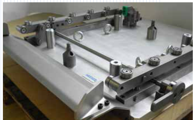
Spannstation für Koordinatenmessmaschine Clamping station for CMM
