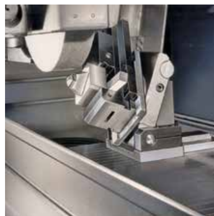
Ausführung EHS auf Sinusträger mit Drehplatte Type EHS on sine table with turn-bolt plate
