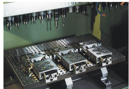
Aufspannplatte mit Unterbausatz
