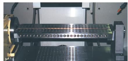
Spannbrücke mit Wiegenplatte
