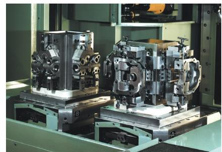
Wechselpaletten mit Aufspannwürfel
